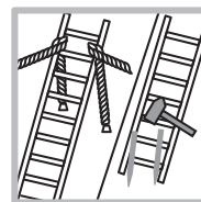
A.19. Zabezpečte štít a podstavu rebríka
