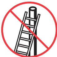
A.20. Presvedčte sa, či je štít rebríka správne zabezpečený
