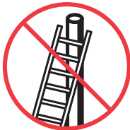
A.20. Meggyőződni róla, hogy a létra csúcsa megfelelően van levédve
