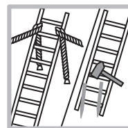
A.19. Zajistěte vrchní a spodní část žebříku
