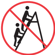
A.13. Tilos a legmagasabb lépcsőfokra állni
